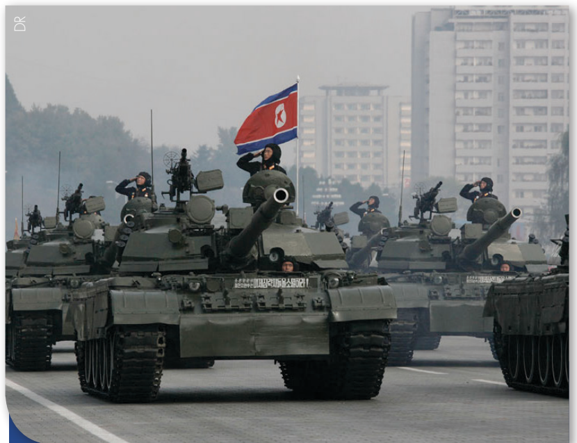
L'armement principal du char Pokpung-ho fut d'abord de 115 mm dans les premières versions puis probablement celui d'un canon de 125 mm, environ 200 exemplaires seraient en service.
