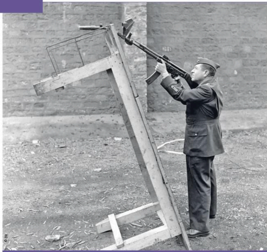
Pendant la 2 e Guerre mondiale, le Krummlauf était un fusil à canon incurvé, mais l'impossibilité pour le tireur de voir la cible augmentait le risque de tirs fratricides et le canon s'usait trop rapidement.
