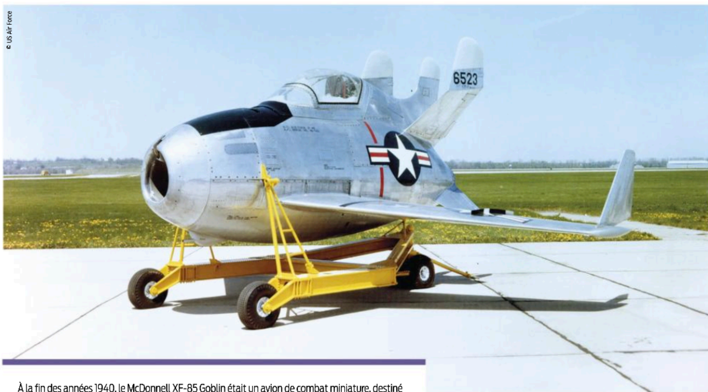
À la fin des années 1940, le McDonnell XF-85 Goblin était un avion de combat miniature, destiné à être emporté dans la soute du bombardier B-36. Une solution qui se révélera peu performante.
