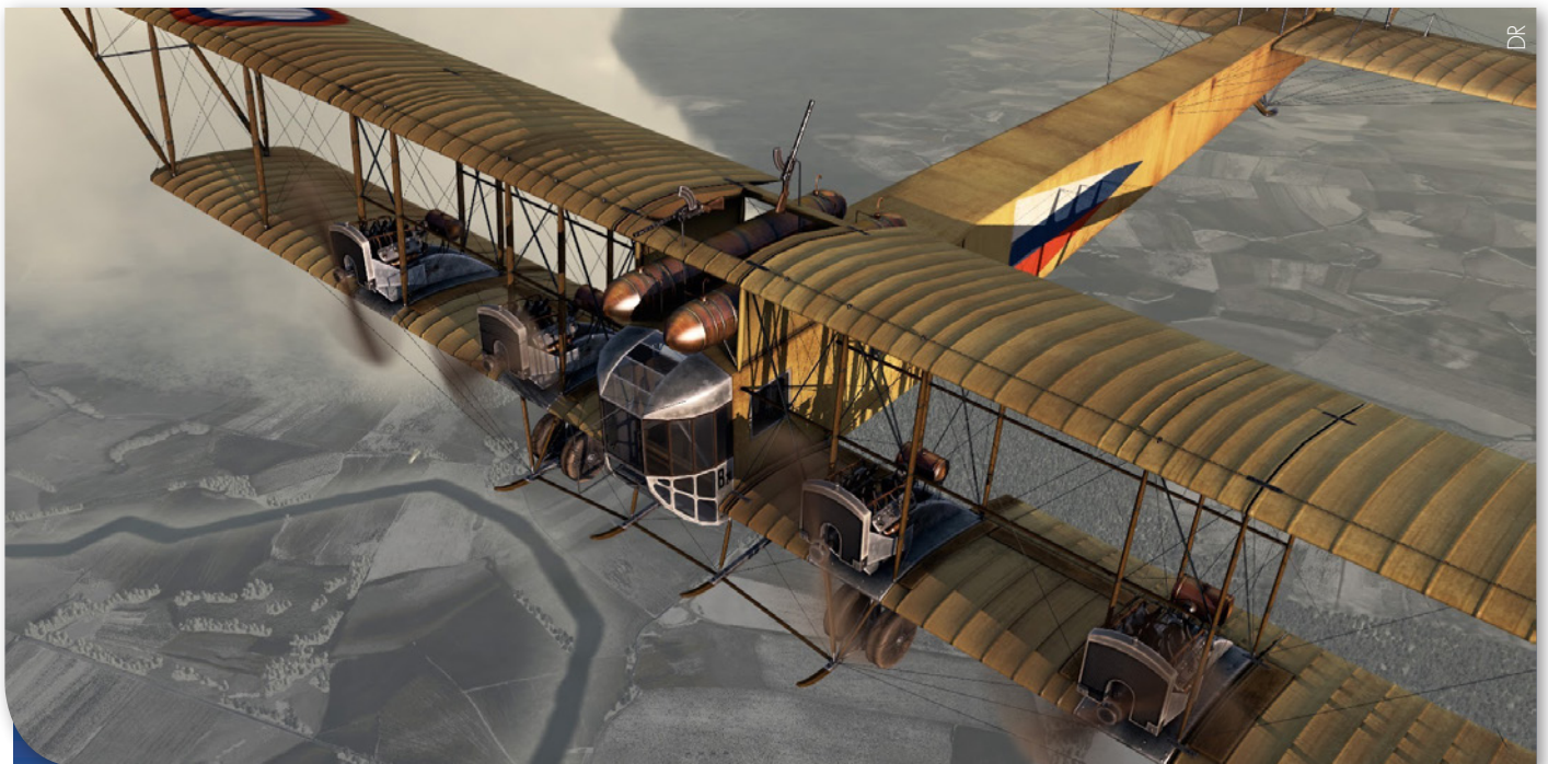
Ilya Mouromets, le bombardier quadrimoteur géant de Sikorsky. Plus de 70 exemplaires seront construits entre 1913 et 1918.
